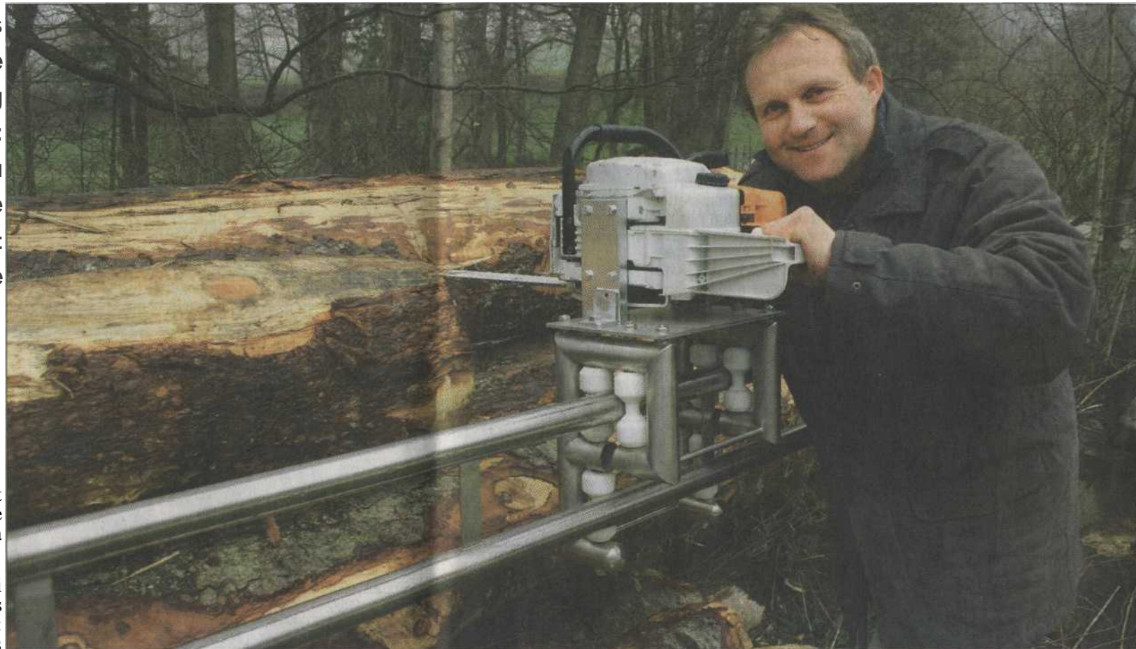
Pierre Messerli et la scie mobile. Cette dernière coulisse sur une structure métallique pouvant atteindre 30 mètres le
